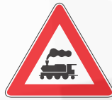
Fig. 9 PASSAGGIO A LIVELLO SENZA BARRIERE
