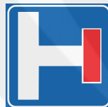
Fig. 311 PREAVVISO DI STRADA SENZA USCITA
