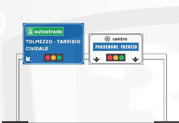
Fig. 232 SEGNALE DI DIREZIONE ALTO CON LANTERNE SEMAFORICHE INCORPORATE
