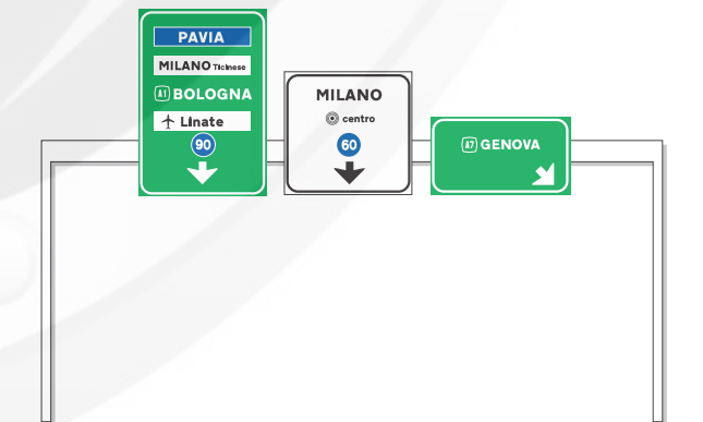
Fig. 252 SEGNALI DI CORSIA CON FUNZIONE DI DIREZIONE CON LE MODALITÀ PER L'UTILIZZO DELLE SINGOLE CORSIE
