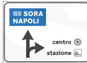
Fig. 233 SEGNALE DI PREAVVISO DI INTERSEZIONE URBANA
