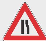
Fig. 19 STRETTOIA ASIMMETRICA A DESTRA
