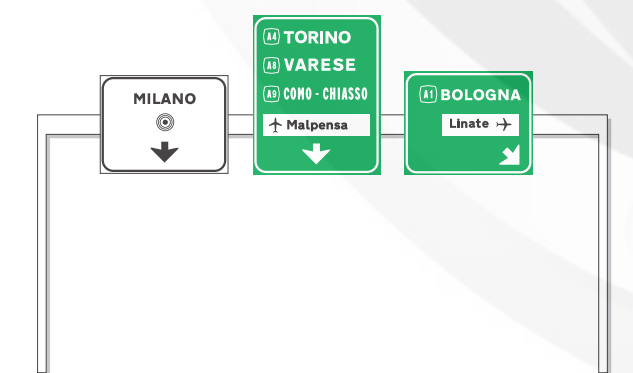
Fig. 250 SEGNALI DI CORSIA CON FUNZIONE DI DIREZIONE
