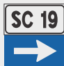
Fig. 270 NUMERI IDENTIFICAZIONE STRADA STATALE + FRECCIA E STRADA COMUNALE + FRECCIA CON FUNZIONE DI DIREZIONE
